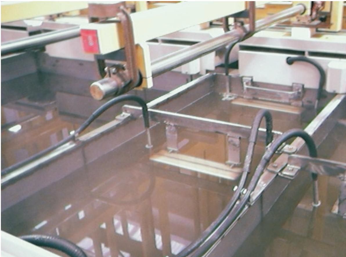
verificare le condizioni dei cavi elettrici, eventualmente sostituirli e sostituire in ogni caso le guaine.
