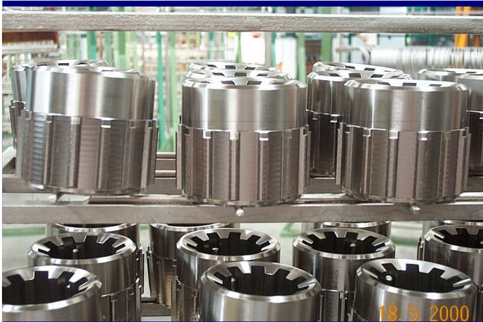
old-02 giunti scorrevoli dopo trattamento
