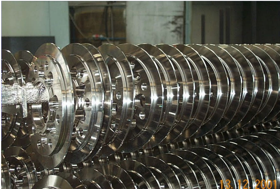
old-01 flange dopo il trattamento
